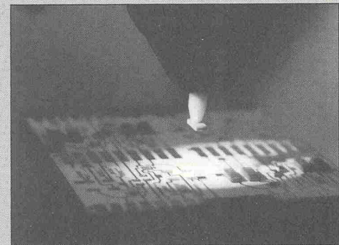
Fig. 1 — Assembling hybrid components to a thin-film circuit Bestückung einer Dünnschichtschaltung mit Hybrid-Bauelementen (a Brown Boveri photograph)
